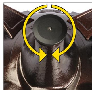
*Die Feder jeweils mit einer halben Drehung justieren. Beurteilen Sie die Anpassung und justieren Sie, falls notwendig, aufs Neue.*
