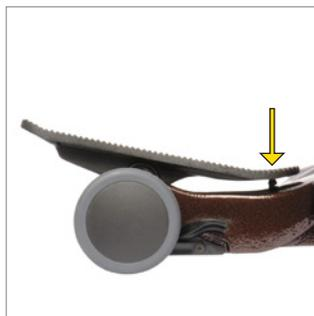
*Die Einstellung der vtFeder, immer mit dem Pedal in der höchsten Tonposition.*
