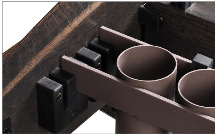
Die Resonator-Aufhängungen an beiden Rahmenendstücken haben eine hohe und eine tiefe Position. Verwenden Sie die hohe Position bei hoher Temperatur und Feuchtigkeit, und die tiefe Position bei kälterer Temperatur.
